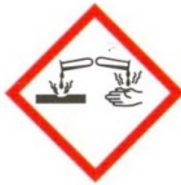
GHS05 Ätzwirkung Bsp. Hautätzend, Korrosiv gegenüber Metallen
