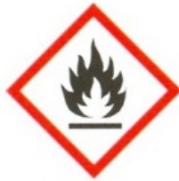
GHS02 Flamme Bsp. Entzündbare Flüssigkeiten
