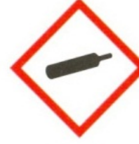
GHS04 Gasflasche Gase unter Druck
